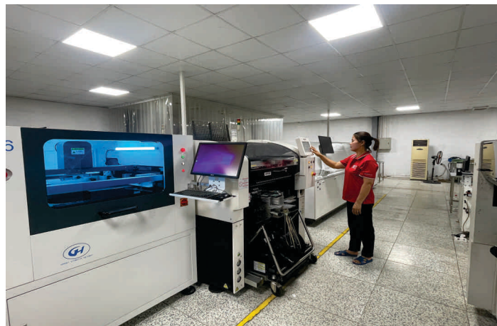
DÂY CHUYỀN LẮP RÁP BƠ MẠCH TỰ ĐỘNG
