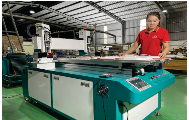
DÂY CHUYỀN LẮP RÁP ĐÈN LED PANEL
